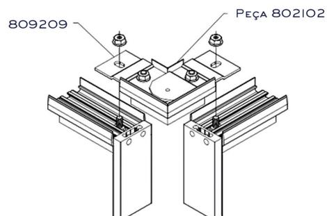
2. Instalar o kit de conexão 809209 com a peça de emenda 802102 utilizando os parafusos inclusos.
