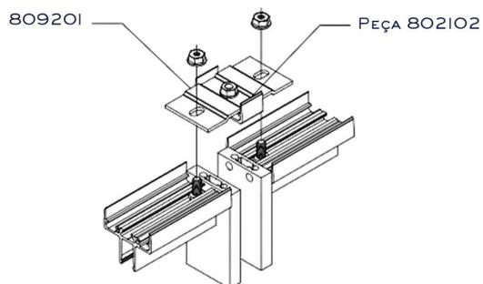
1. Instalar o kit de conexão 809201 com a peça de emenda 802102 utilizando os parafusos inclusos.
